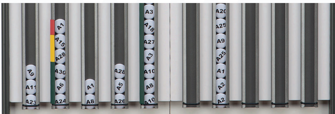
Abb. Detail FiFo-Bahn bestückt mit Coins und Magnetstreifen in Ampelfarben – die Lösung im Kleinteile- oder Palettenlager.
